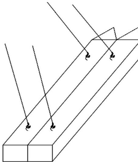
Схема строповки фундаментов (подножников) за монтажные отверстия при перемещении в вертикальном положении
