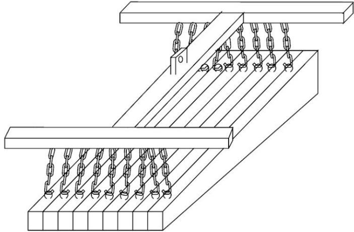
Схема строповки свай
