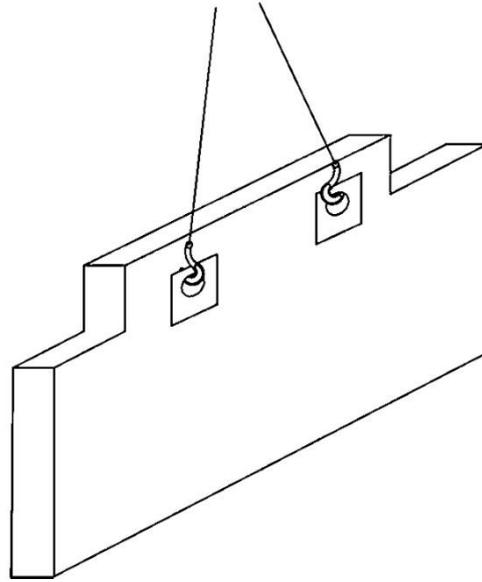
Схема строповки стоек вибрированных СВ
