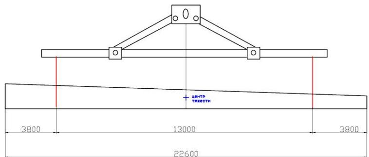
Схема строповки стоек конических СК 26
